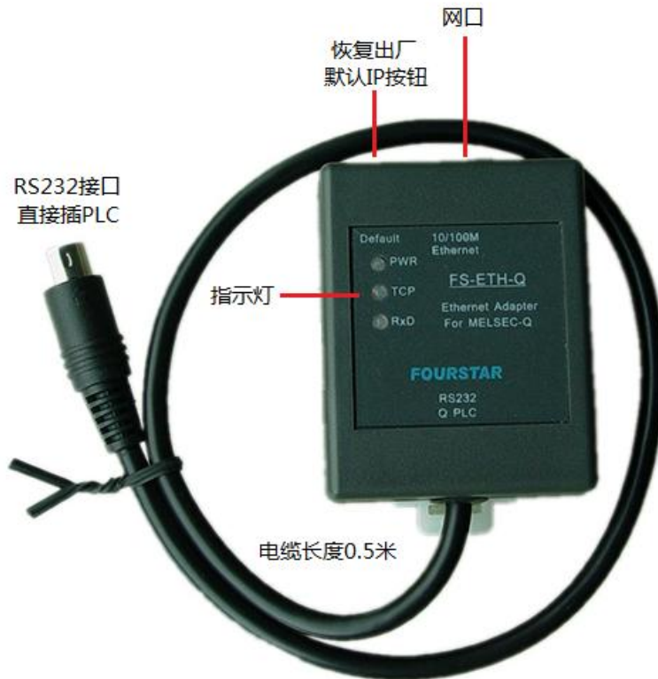
图3-1 FS-ETH-Q的外部结构及各部件说明
