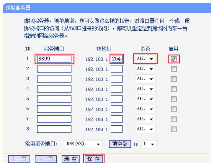
图5.3-3 路由器的端口映射设置
