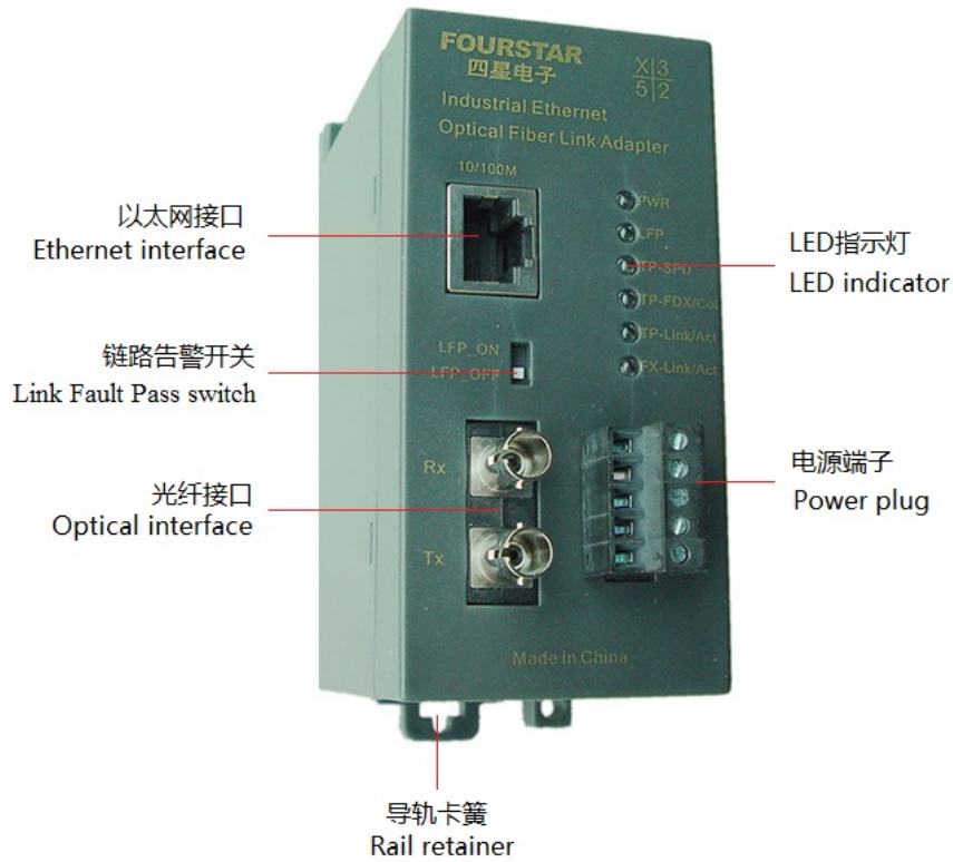
图 3-1 FIB-IE-M 外部结构图
