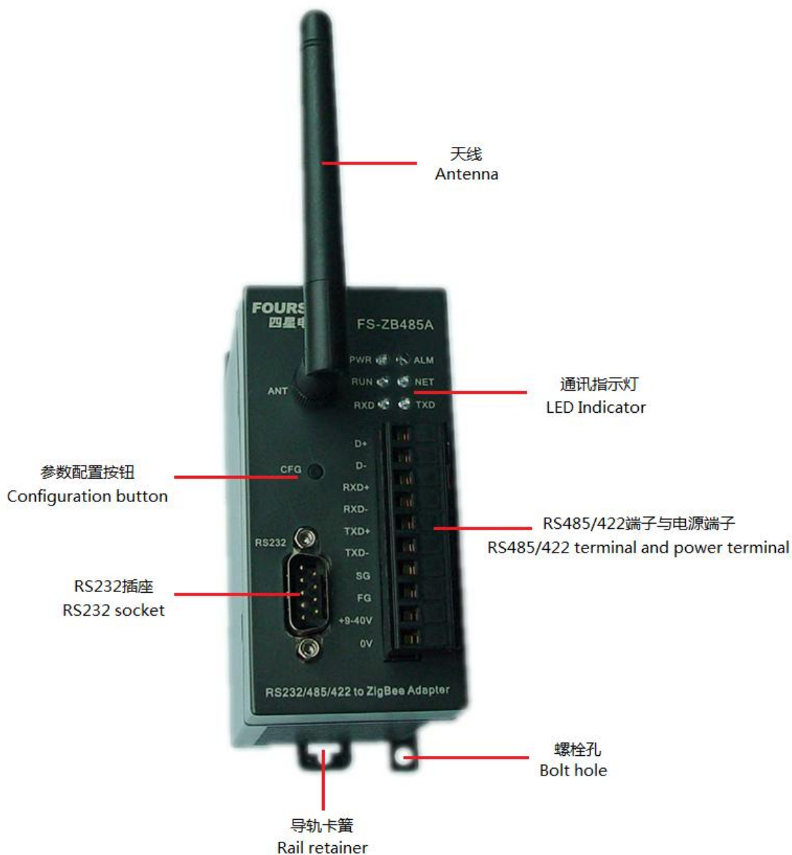
图3-1 FS-ZB485A适配器的外部结构及各部件说明
